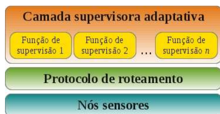
Figura 4. Arquitetura do sistema com o protocolo de roteamento, a camada supervisora adaptativa e suas funções de supervisão.
