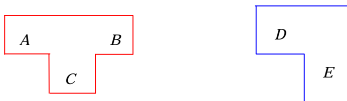
Figura 3-2 Diagramas-T para representar tradutores e interpretadores (Extraída de Spinellis-94).
